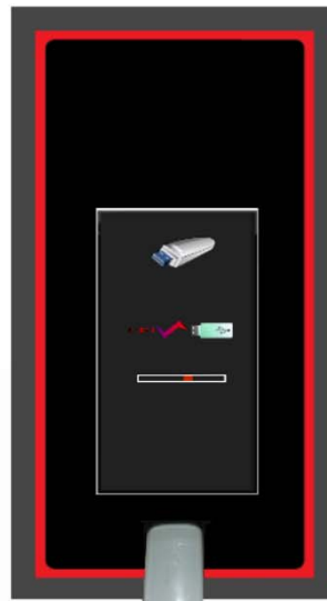
De overdracht begint bij het inbrengen van de USB-stick in de USB poort.
